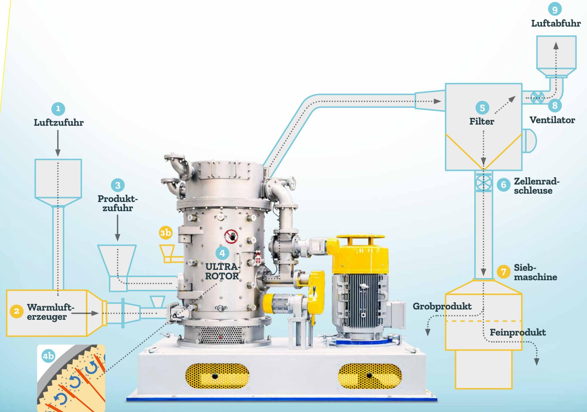
**1** Die benötigte Luft wird von außen angesaugt. Bei Bedarf kann sie über einen Luftansaugsfilter gereinigt werden.
